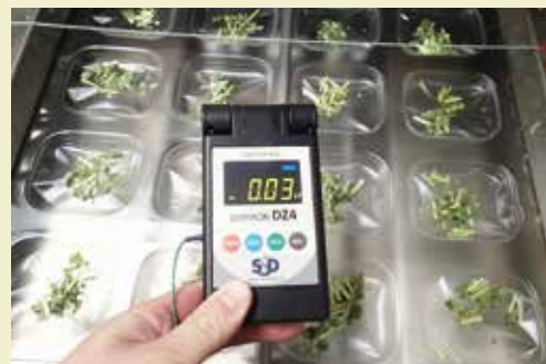
除電処理後は容器外に具材は拡散せず、作業効率が大きく改善した
